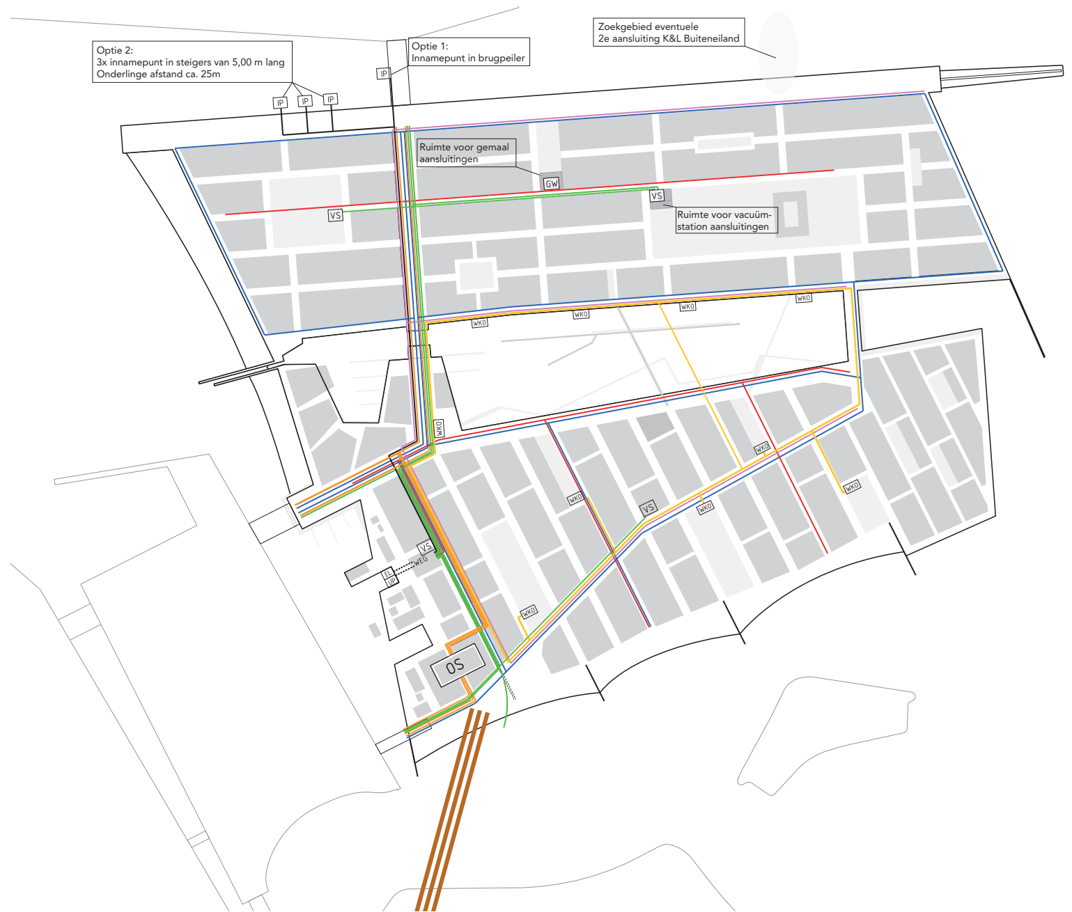
Afb. 10.6 Kaart: Masterplan Kabels en Leidingen Strandeiland. De op de kaart aangegeven locaties van WKO-bronnen, vacuümstations, inname- en uitredepunten zijn indicatief. De definitieve locaties volgen bij de nadere uitwerking van het WKO-systeem.
