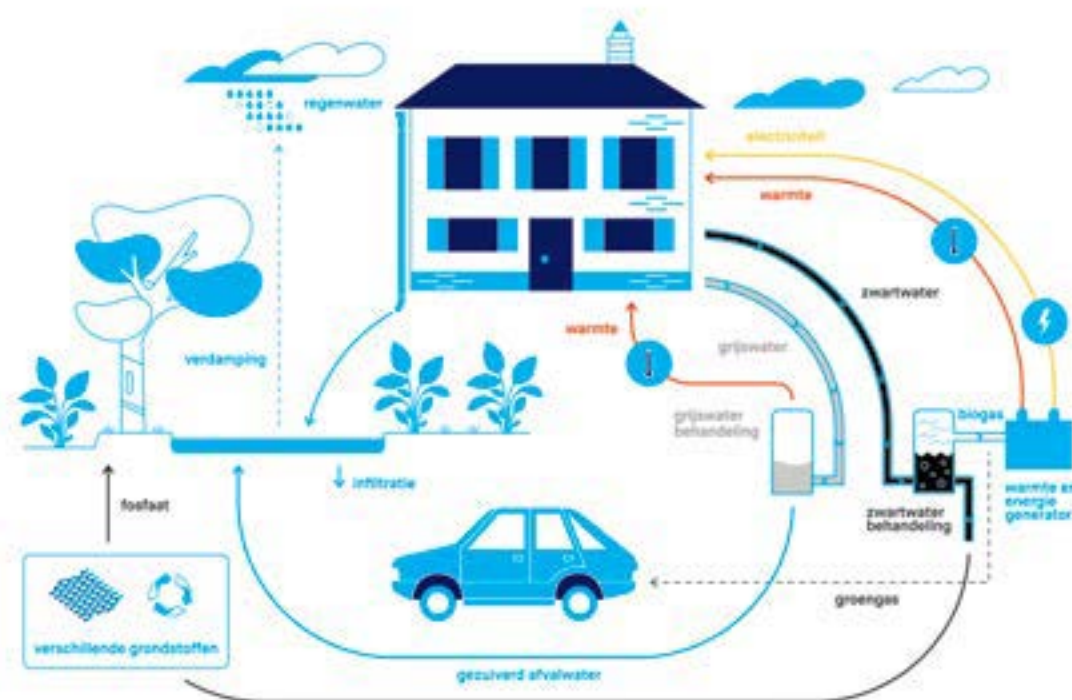
Afb. 8.4 Nieuwe sanitatie geïntegreerd met een energiesysteem
