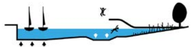
Lokaal de bodem verdiepen ten behoeve van recreatiemogelijkheden
